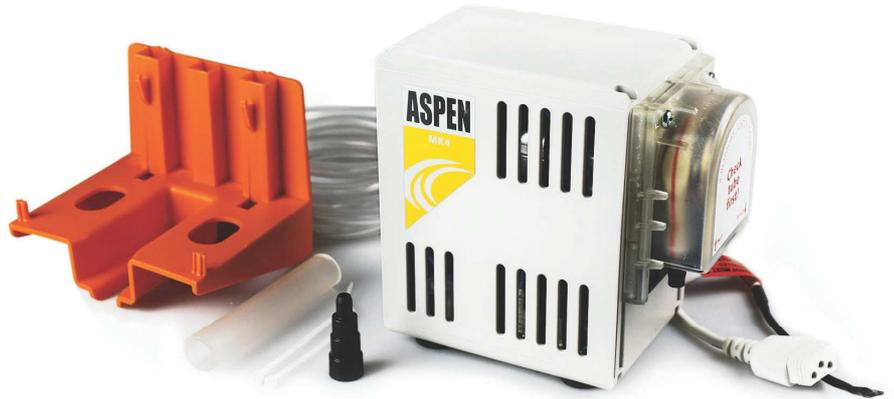
La pompa peristaltica MK4 funziona mediante due sensori di livello dell'acqua. Il sensore inferiore entra in contatto con l'acqua e cede calore determinando una differenza di temperatura rispetto al secondo attivando la pompa.
